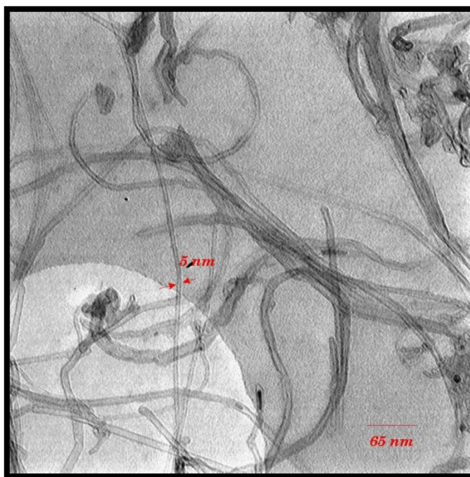
شکل (۲-۳) یک تصویر TEM نوعی از نانولوله های کربنی تک دیواره رشد داده شده بر روی کاتالیست
