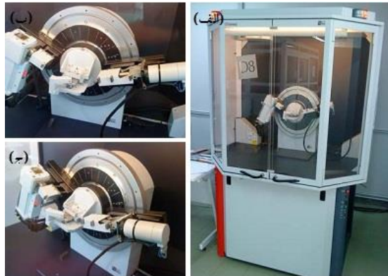
شکل ۱-۲ (الف) دستگاه پراش اشعه X مدل Bruker AXS (ب-ج) محل قرار گرفتن لایه.
