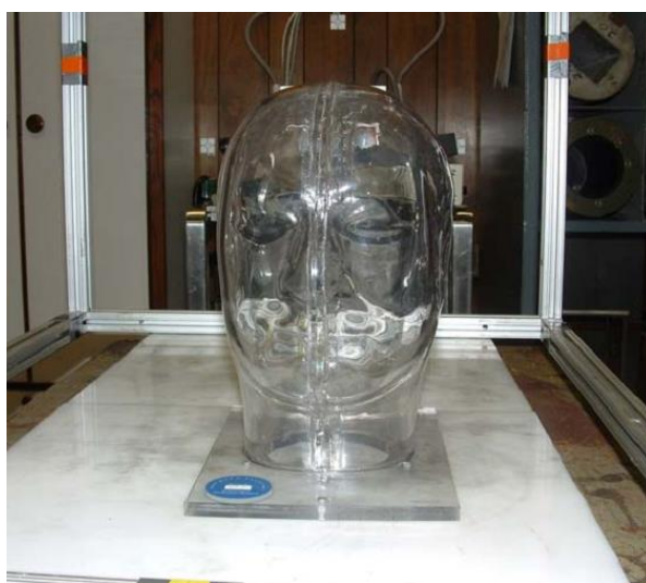
شکل ۲-۱۳. تصویر فانتوم طراحی شده برای آزمایش که از آب یونیزه پر شده است [۴۶]
