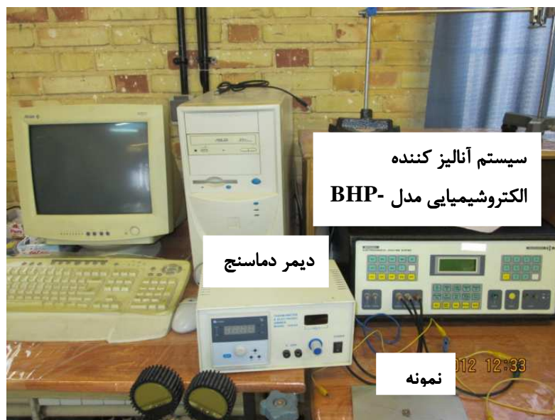
شکل ۳-۱۱: سامانه اندازه گیری جریان - ولتاژ مورد استفاده ما در آزمایشگاه
