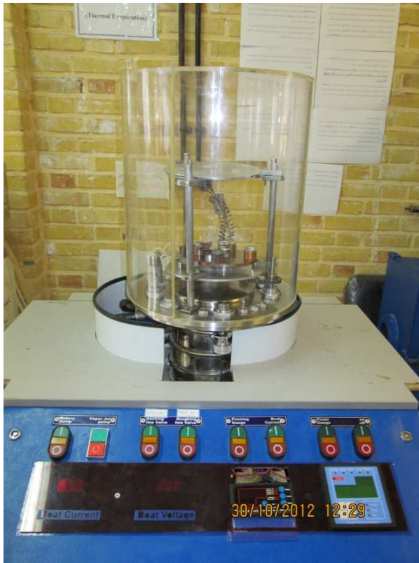
شکل ۳-۹: سمت راست تصویر شماتیک از دستگاه تبخیر در خلأ و سمت چپ دستگاه مورد استفاده در آزمایشگاه
