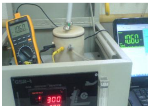
شکل ۳-۵: راکتور حسگر گازی موجود در آزمایشگاه رشد بلور دانشگاه صنعتی شاهرود.
