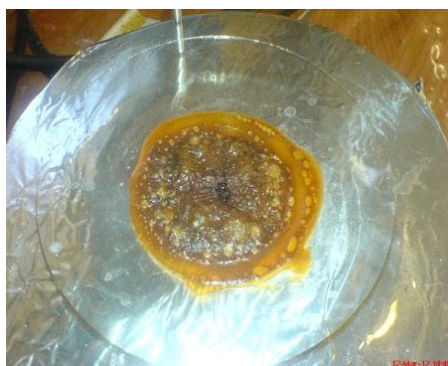
شکل ۴-۳: ژل تهیه شده به روش سل-ژل.
