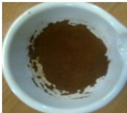
شکل ۴-۴: پودرهای تهیه شده به روش خود احتراقی.
