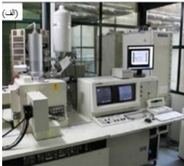
شکل ۳-۸- (الف) نمایی از میکروسکوپ الکترونی روبشی گسیل میدانی (FESEM Hitachi S,4160) مورد استفاده در این مطالعه مستقر در دانشگاه تهران (ب) تصویر شماتیک از اجزاء داخلی مسیر عبور باریکه الکترونی تا سطح نمونه در سیستم SEM [۳۶].
