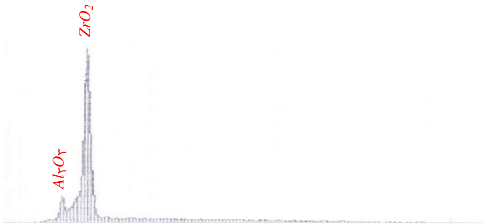
شکل ۴-۲۸: نمودار EDX از یک دانه ی زیرکونیا از نانوکامپوزیت شامل ۷۰٪ حجمی آلومینا.
