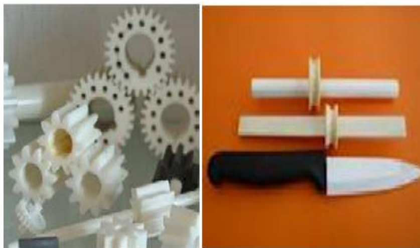
شکل ۲-۹: کاربرد زیرکونیا بعنوان جایگزین فولاد.
