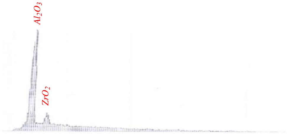
شکل ۴-۲۷: نمودار EDX از یک دانه ی آلومینا از نانوکامپوزیت شامل ۷۰٪ حجمی آلومینا.
