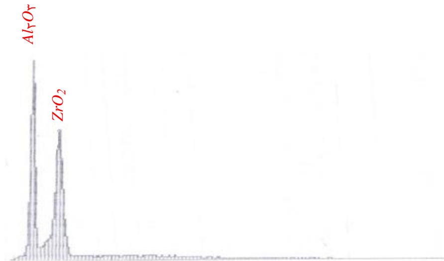
شکل ۴-۲۶: نمودار EDX از نمونه شامل 70\% حجمی آلومینا.
