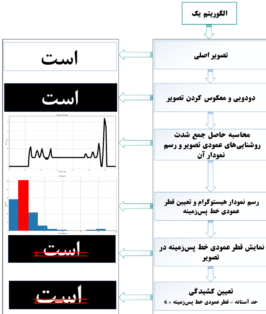
شکل ۳-۲. فلوجارت الگوریتم ۳-۱ به همراه یک مثال. تشخیص حد آستانه براساس قطر عمودی خط پس زمینه.
