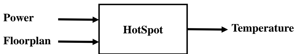
شکل ۲-۲: ورودی‌ها و خروجی شبیه‌ساز HotSpot برای پیش‌بینی دما
