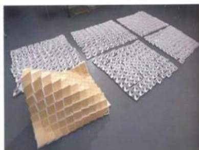
شکل 2-25- توسعه ساختار سطوح پاسخدهنده به محیط با الهام از میوه کاج
