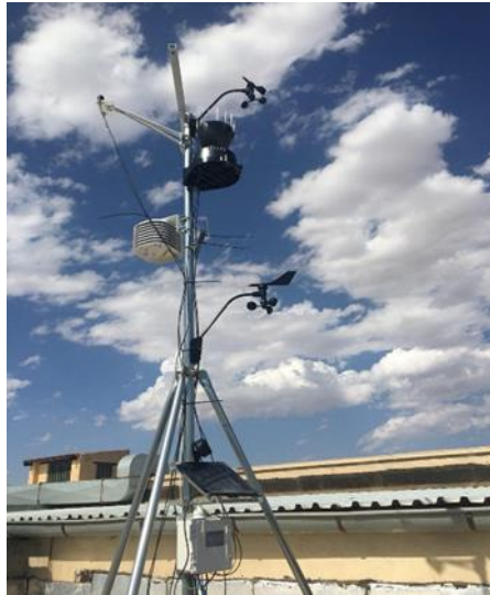
شکل ۳-۱۳. نمایی از ایستگاه هواشناسی هوبو ۳۰۰۰ RX-، ماخذ: نگارنده.
