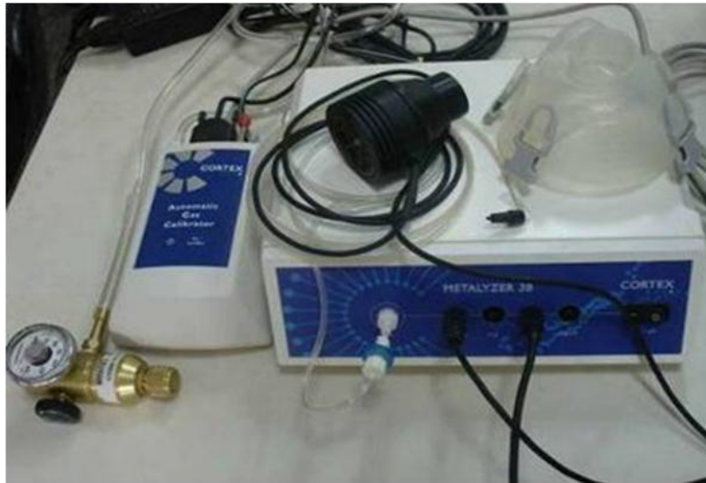
شکل (۳-۵)، دستگاه گاز آنالایزر و ضمایم آن
