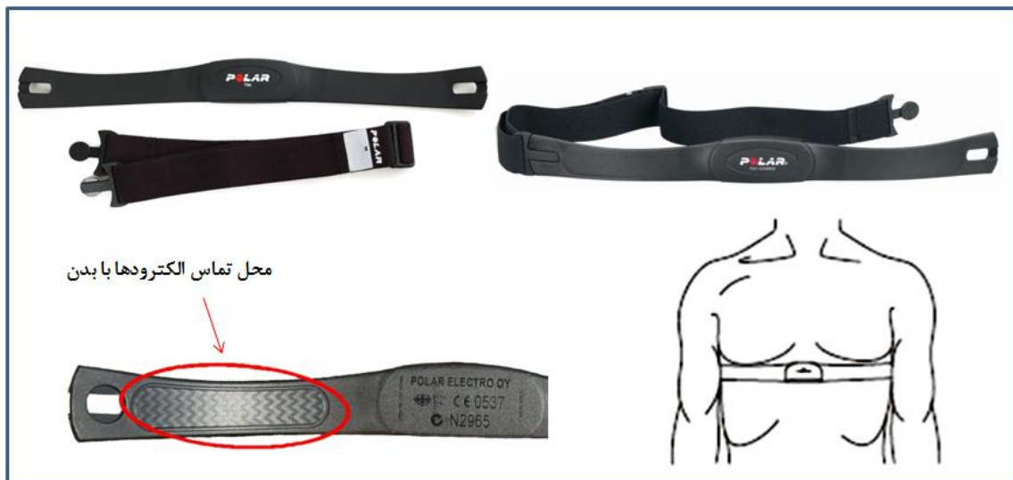
شکل (۳-۴)، ضربان‌سنج پلار و محل قرارگیری آن بر روی بدن
